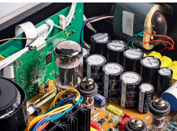
W zasilaczu użyto dwóch lamp: 6550 i 6H30. Pojemności filtrujące są znaczne (10 x 470 µF)
