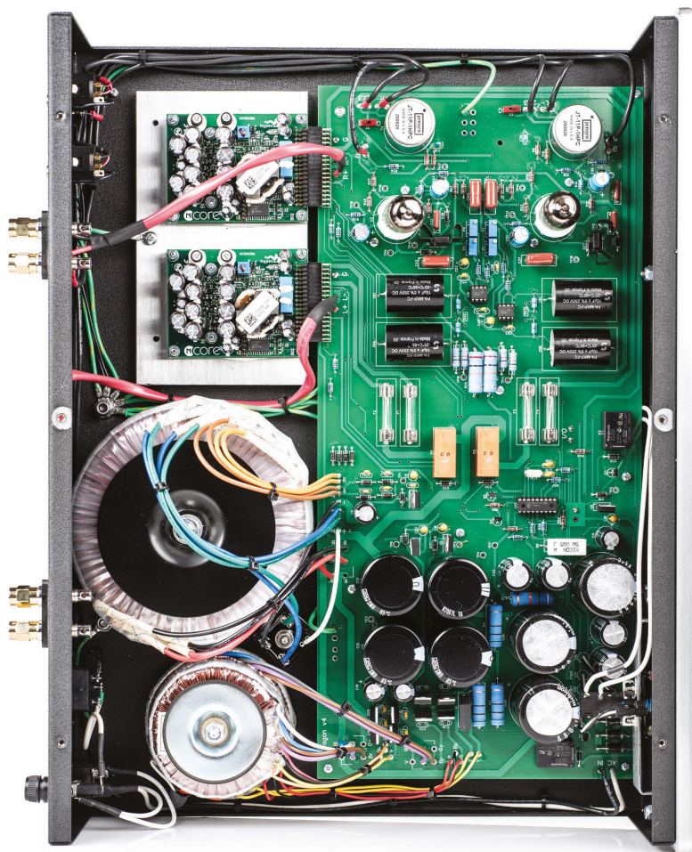
Nietypowy widok. Płytkę jak we wzmacniaczu zintegrowanym, trzy transformatory i stopnie końcowe w klasie D. Sęk w tym, że to działa!
