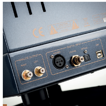
Zestaw wejść jest kompletny, ale warto zwrócić uwagę na wejścia symetryczne i koaksjalne, które umożliwiają uzyskanie wyższej jakości dźwięku niż USB Audio.
