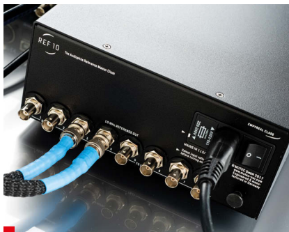
Ref10 ma 6 wyjść zegarowych 10 MHz o impedancji 75 Ω i dwa 50-omowe.
