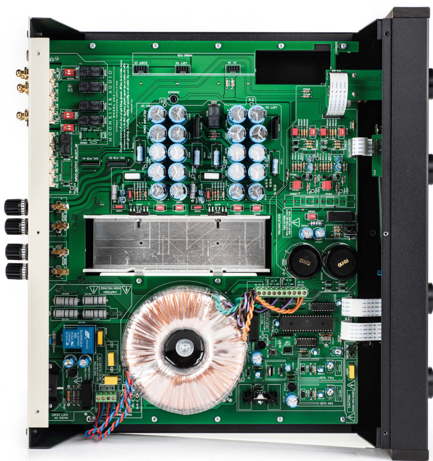
Transformator ma moc 250 VA, aluminiowy radiator oddaje nadwyżkę ciepła do spodu.
