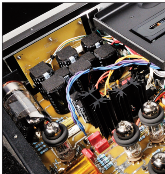
CD8 ma całą sekcję analogową opartą na lampach, a nawet część zasilacza wykorzystującego tetrodę 6922 w roli prostownika
