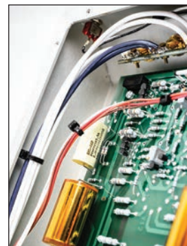
Złote kondensatory sygnałowe nie mają oznaczeń. Stopnie wejściowe bazują na tranzystorach FET.
